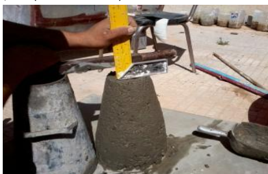
الشكل (5) يوضح الادوات المستخدمة وطريقة الاختبار
