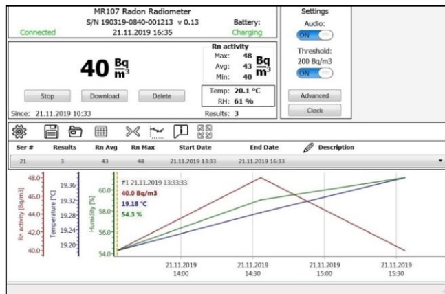
الشكل (3 أ) عينة لبعض البيانات وطيف العوامل البيئية التي تؤثر في قياس تركيز غاز الرادون
