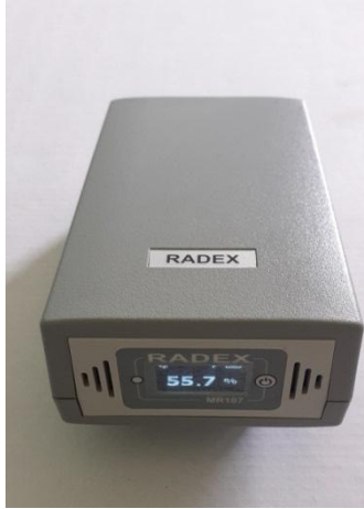
شكل ( 2 ) : الجهاز المستخدم لقياس تركيز غاز الرادون في هذا البحث
