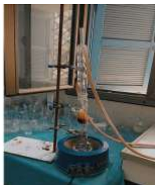
شكل (3): جهاز السوكسلت المستخدم في الاستخلاص الساخن
