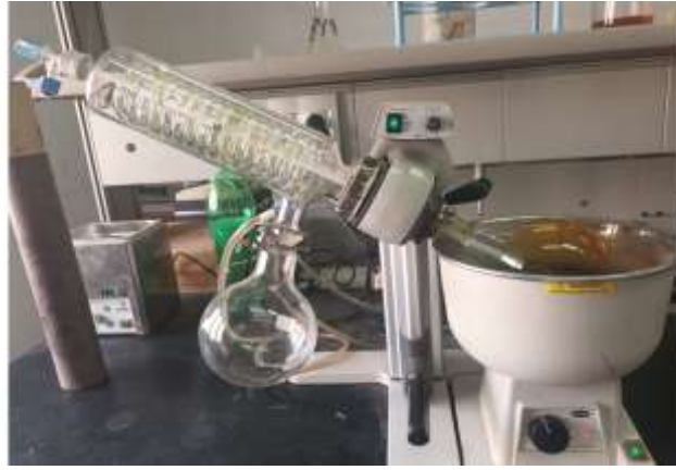
شكل (4): المبخر الدوّار المستخدم لتركيز المستخلص
