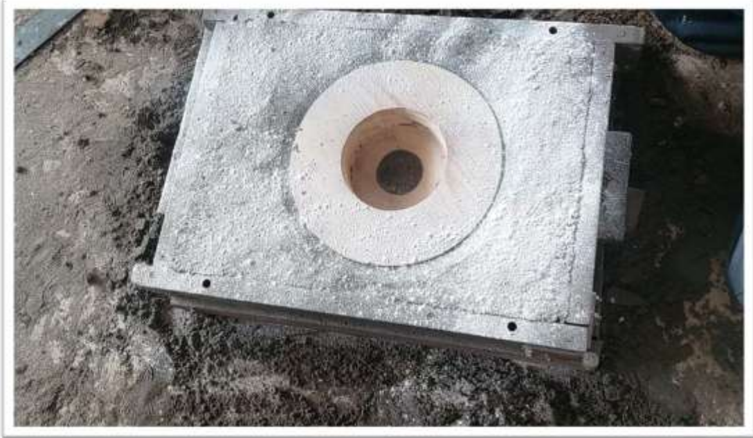
شكل (3) قالب السباكة
