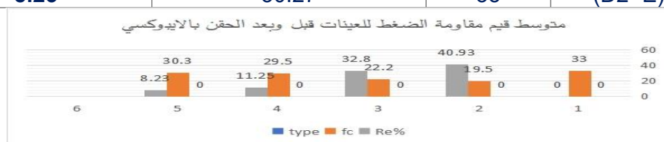
الشكل (2): قيم التخفيض ومقاومة الضغط قبل وبعد حقن الايوكسي [ 24 ]
