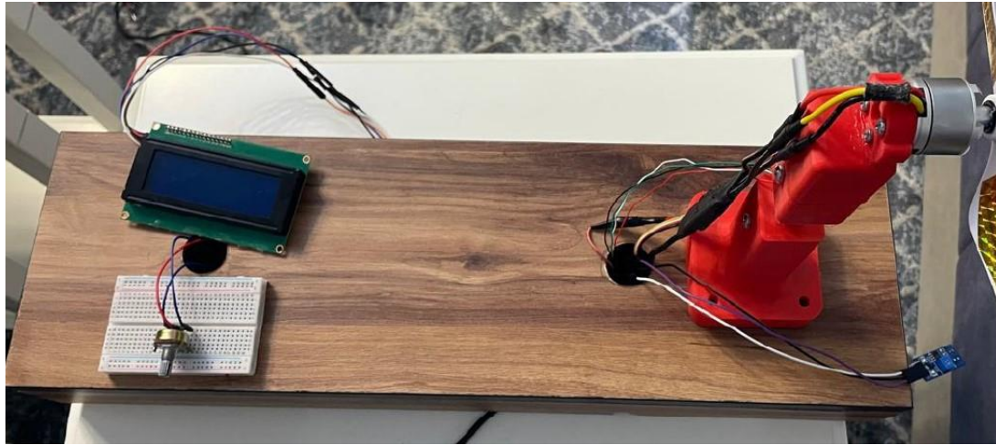
شكل 7 نموذج منصة قياس كفاءة المحرك
