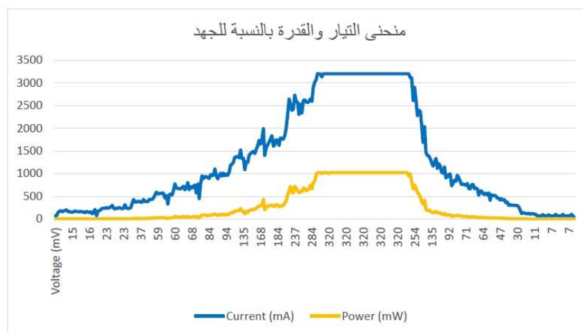
شكل 6 : منحنى الجهد بالنسبة للزمن ومنحنى التيار و القدرة مع الجهد
