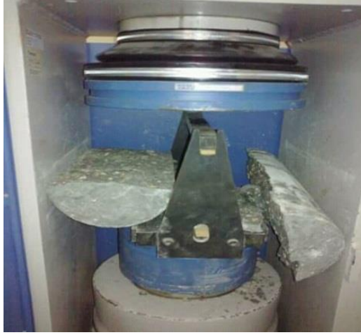
شكل (7) يوضح اختبار الشد غير المباشر بعد انهيار العينة
