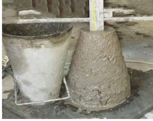
الشكل (5) توضح إختبار الهبوط لأحد عينات الخلطة الخرسانية
