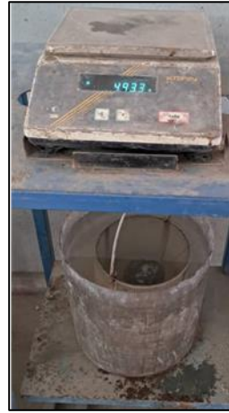
الشكل 7 العينة مغمورة في الماء (الوزن المغمور) الشكل 8 وزن العينة مشبعة جافة السطح
