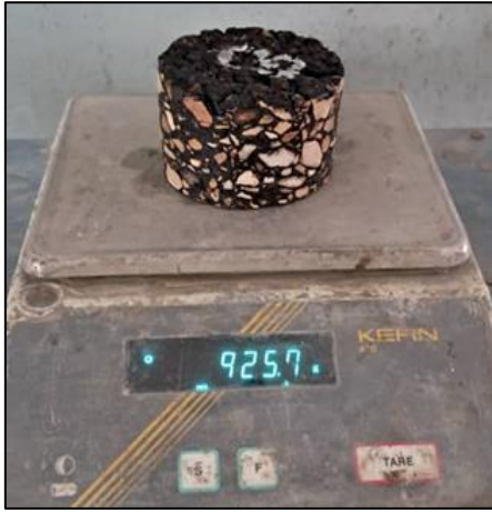
الشكل 7 العينة مغمورة في الماء (الوزن المغمور) الشكل 8 وزن العينة مشبعة جافة السطح
