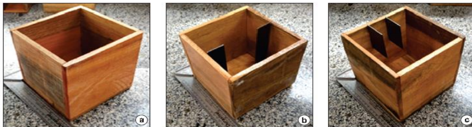
شكل (1) تمثيل للعينات والشقوق الاصطناعية والعينات المرجعية [25]
