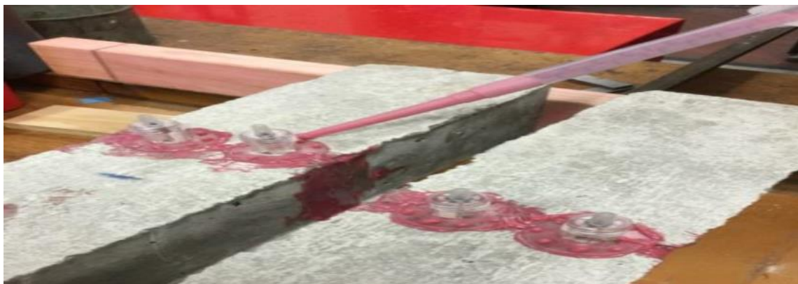
الشكل (3) كسر نموذجي لعوارض الاختبار تحت الحمل الرأسي [26]
