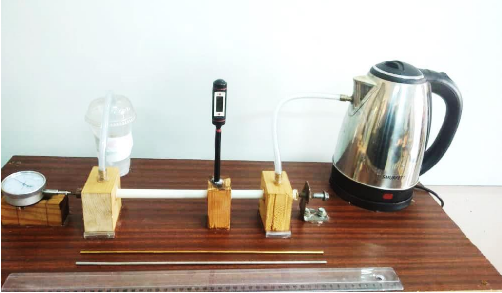
الشكل (1) تركيب جهاز لإيجاد معامل التمدد الحراري الطولي.
