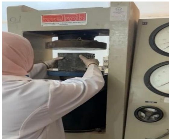
الشكل (3) يوضح مقاومة الضغط للخلطة المرجعية
