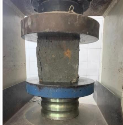
الشكل (6) يوضح مقاومة الضغط للخلطة الرابعة
