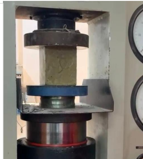
الشكل (7) يوضح مقاومة الضغط للخلطة الخامسة
