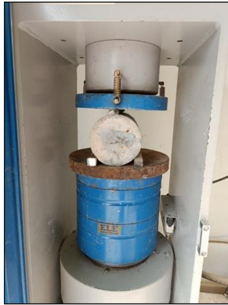
شكل (3-6) اختبار الشد غير المباشر
