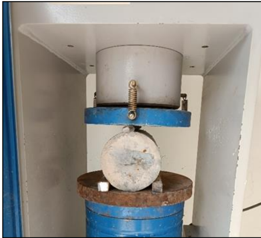
شكل (3-4) اختبار الشد غير المباشر
